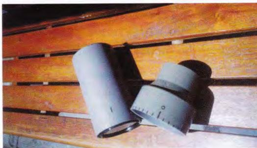
**6-P2** (a) Sudut pada julat sekata, ditanda pada penyambung PVC yang memegang Polaroid / Angles at regular intervals are marked on PVC joint holding the polaroid (b) Titik rujukan ditanda pada paip PVC yang memegang Polaroid / A reference point is marked on the PVC pipe holding the other polaroid
