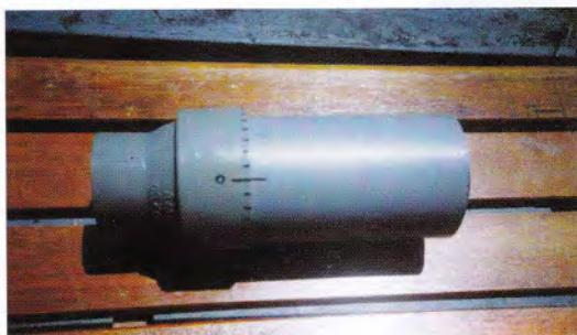
**6-P4** Peninjau Polaroid dilaraskan pada nilai  $\theta=0^\circ$  / The Polaroid viewer adjusted to a value  $\theta=0^\circ$
